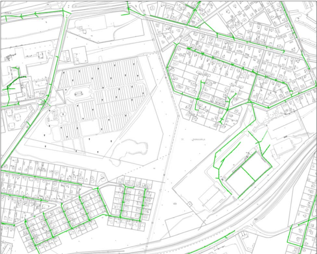
Kuva 44. Suunnittelualan hulevesiverkosto (Trimble Locus Cloud 9.5.2023).
